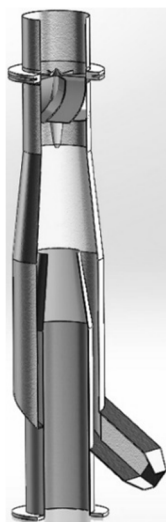
Рис. 1. Запатентованная конструкция прямоточного циклона
